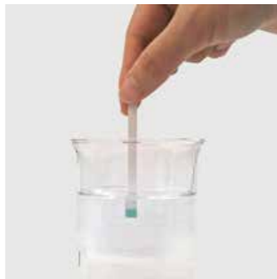
2. 将测试条浸入测试样品中，润湿测试条的反应区。然后，甩掉测试条上多余的液体，或在样品容器的边缘擦去。
